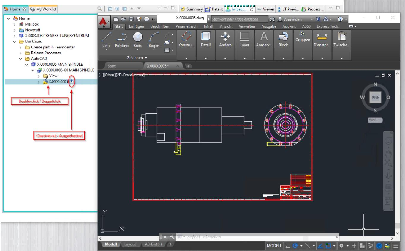
Hinweis: Die Datei wird beim Öffnen in ein lokales Verzeichnis im temporären Order Ihres Computers ausgecheckt. Alle Änderungen werden dort gespeichert, solange das Programm AutoCAD geöffnet bleibt. Vergewissern Sie sich ggf., dass am Dataset ein „Checked-Out“ Symbol angezeigt wird.
