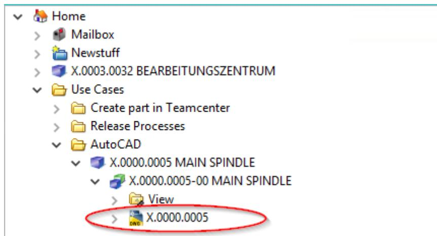
Zum weiteren Bearbeiten der AutoCAD Datei führen Sie einen Doppelklick auf dem Dataset aus. AutoCAD wird geöffnet und die Datei geladen.
