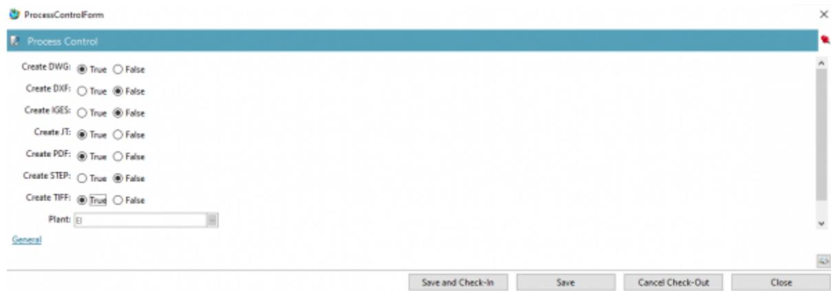
Wählen Sie die Neutralformate aus und drücken Sie „Save and Check-In“. Anschließend drücken Sie den „Perform Task“ Knopf in der oberen Leiste im Teamcenter Navigator.
