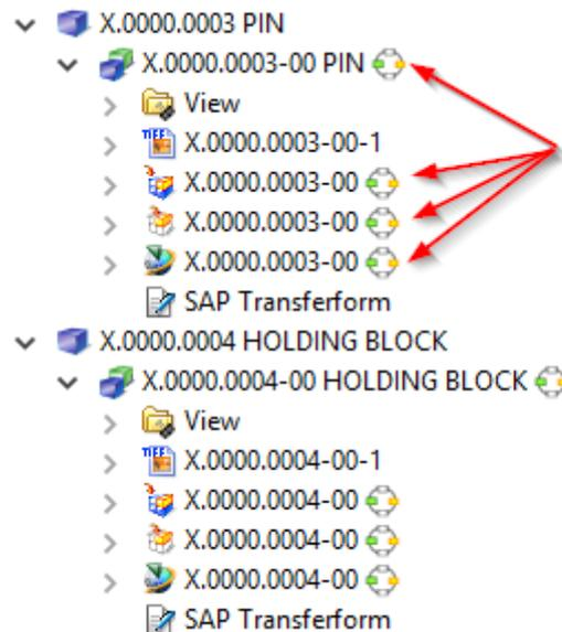
Sobald der Workflow abgeschlossen ist, wird der Freigabe-Status (in diesem Fall „ER“) als Symbol und textuell an den Objekten angezeigt. Außerdem sind die erzeugten Neutralformate als Dataset an die Revision angehängt und ebenfalls freigegeben worden.
