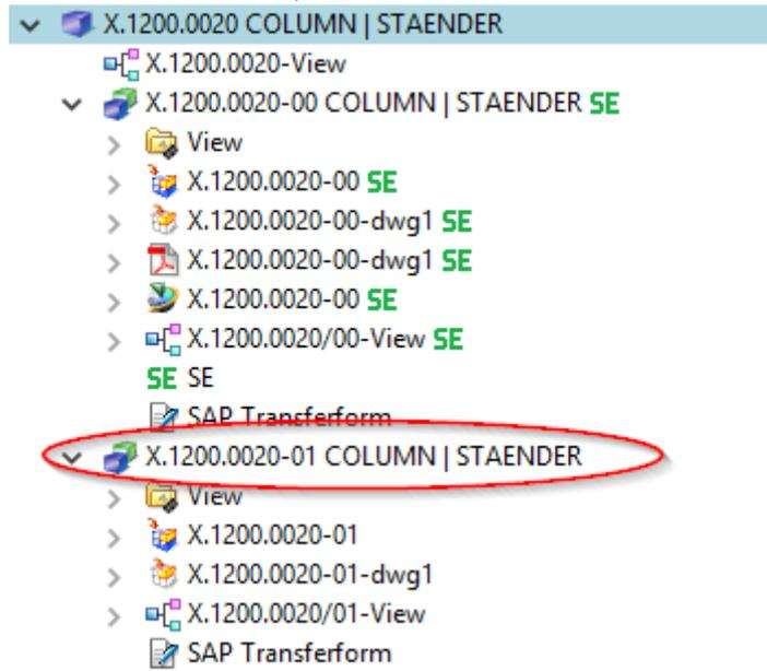
Das Modell (UGMASTER) und die Zeichnung (UGPART) werden beim Revisionieren kopiert. Bitte beachten Sie, dass Neutralformate wie PDF oder JT nicht übernommen werden. Diese werden bei Bedarf oder spätestens bei der Freigabe neu erstellt.
